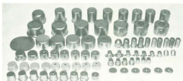
「トランスファープレス」加工品の一例 ↑ 左から110t, 110t, 110t, 200t, 75t, 75t →
